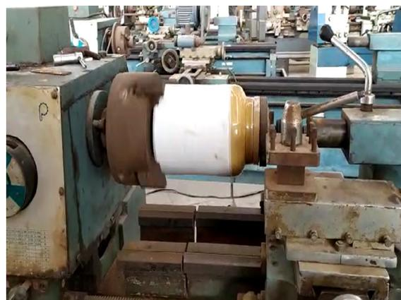
Figure 2 : Dry ball milling (jar milling) setup
